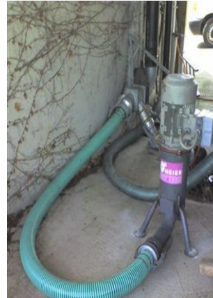
Saugrohrmischer mit Saugschlauch Anschlüssen für den mobilen Einsatz
