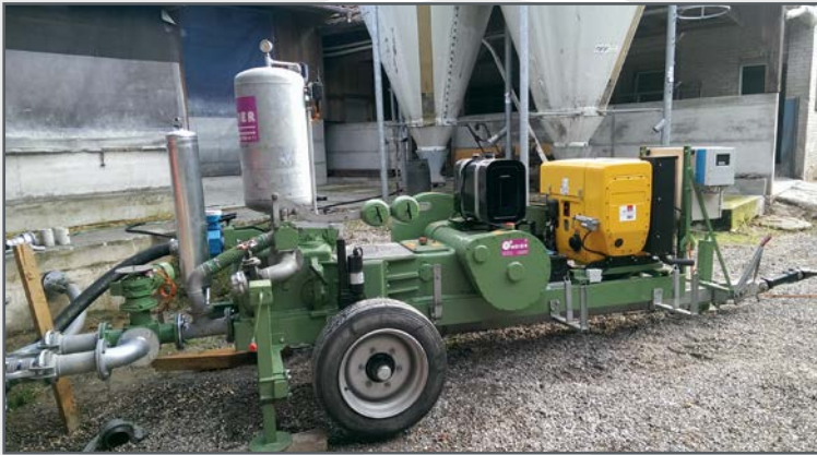
H-60-OSG, Hatz Dieselmotor mit Schalldmpfer
