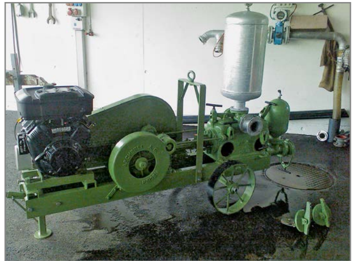
H-11 mit aufgebautem Benzinmotor
