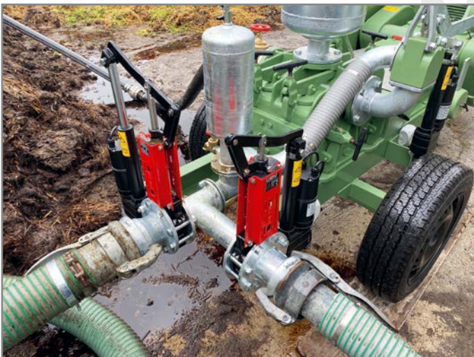
Saugseite mit Plattenschieber gesteuert
