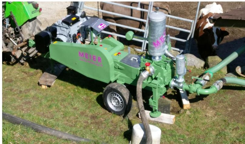
Unsere neue doppeltwirkende Oelbad-Zweikolbenpumpe **Typ H-303-0-SG** trägt den gestiegenen Anforderungen der Praxis voll Rechnung. Die Pumpe hat eine **konstante** Fördermenge von bis zu 850 l/min. Gülle - oder 1000 l/min Wasser.
