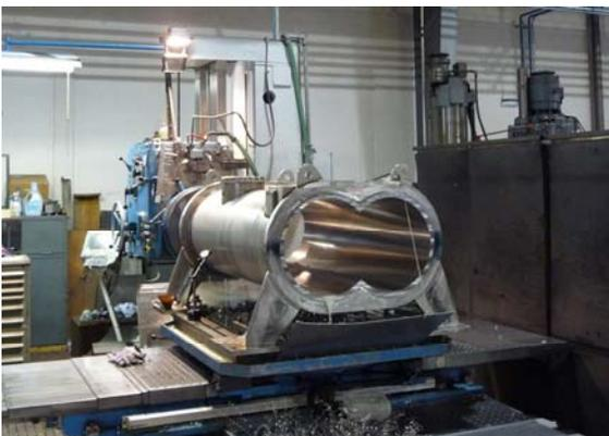
**Horizontal Fräs- und Bohrwerk, konventionell**
