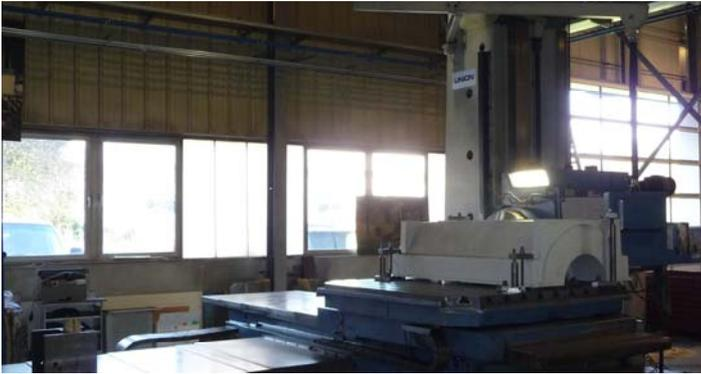
**CNC Horizontal Fräs- und Bohrwerk 5-Achsen**
